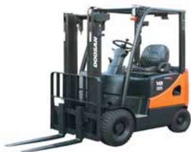
D15S / D18S-5 & D20SC-5 1,500kg 1,750kg 2,000kg Diesel, Pneumatic Tire
